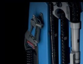
Pistolet de désinfection pour désinfecter la machine à la fin du quart de travail (disponible uniquement avec le Disinfectant)
